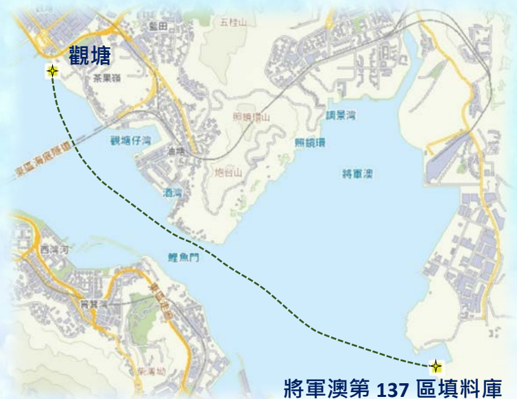
▲ 為減低工程對附近環境及交通的影響，工程將會採用海路方式出泥，以避免塵土飛揚及加重交通負荷。上圖為海路方式出泥的路線圖。
