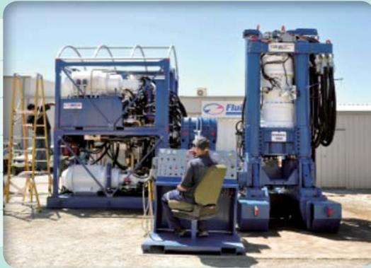
在挖掘豎井之前，我們在連接隧道的末端，即豎井的底部安裝一個鑽頭。鑽頭將會由地底反方向向上挖掘豎井，所有挖掘時所產生的塵埃及噪音將局限於地底。
