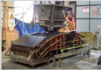
工人小心翼翼將混凝土澆注於模具內
