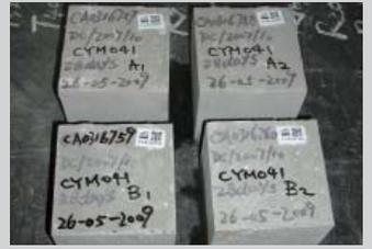
為確保預製件之混凝土強度達標，工程人員需將同一批次的混凝土製成小磚塊送往實驗所進行測試
