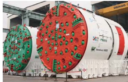
東面及西面隧道鑽挖機已分別投入運作
